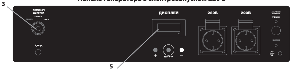
Панель генератора з електрозапуском 220 В та ATS
